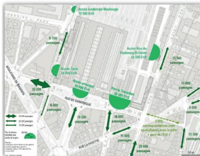
Figure 7 : plan des accès piétons à la gare du Nord. Source : pièce B 2b_12, p. 44
